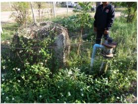
FIGURE 25: PUMP ON UNEVEN LAND WITH WIRES WRAPPED AROUND THE DRIPPING SECTION
