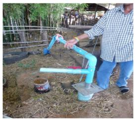
FIGURE 18: WATER PUMP FOR UNDERGROUND WATER
